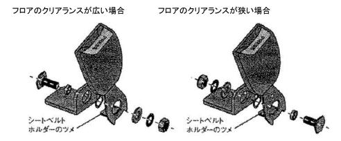
シートベルトキャッチャー用ステーにシートベルトキャッチャーのツメが干渉する場合はツメをカットしてください。
